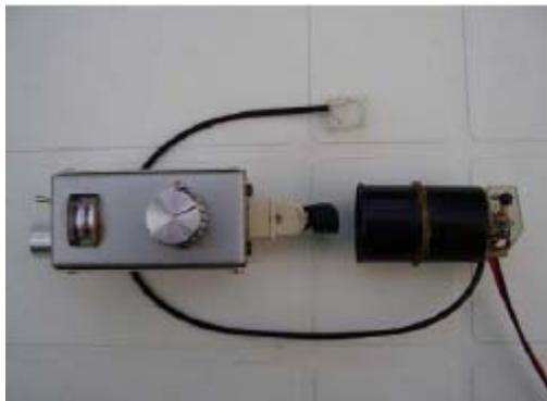
I Grid Dip Meter, utilizzati come ondometri, richiedono che questi vengano posizionati praticamente in contatto con i circuiti risonanti in esame, o punti caldi per la radiofrequenza, onde poter captare la sufficiente energia per "smuoverli". Questo è valido a meno che non si stia operando su circuiti ove è presente una forte potenza, cosa che non avviene in apparati QRP od in fase di test, quando si ha ancora tutto sottoalimentato o fuori frequenza.
